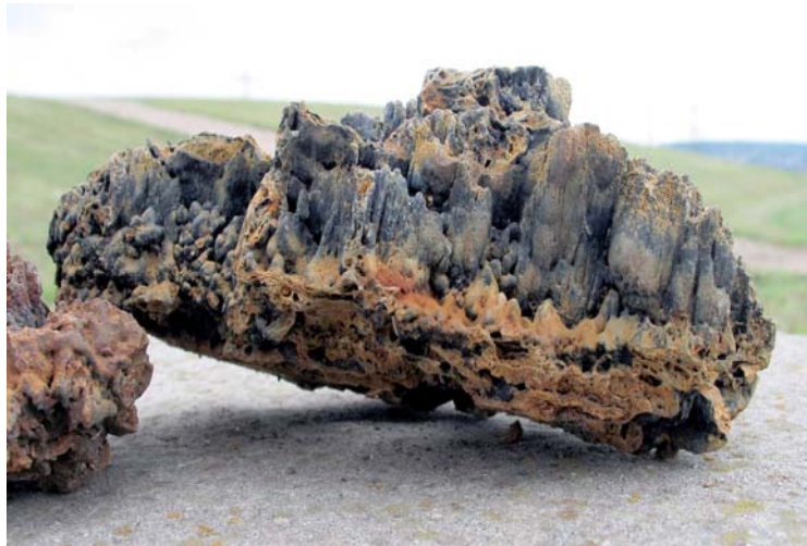
Extreme deponiespezifische Inkrustation (20 cm stark)
