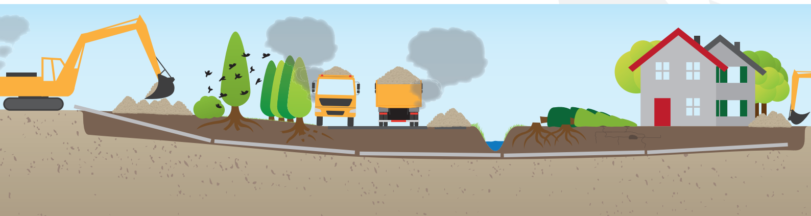
Abb. 1: Traditionelle offene Bauweise mittels Rohrverlegung in Gräben
