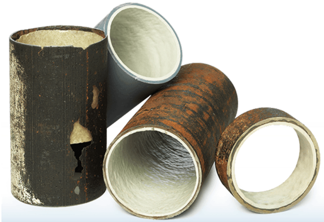
Bild 5: Mit Glasfasermanschette zur Instandsetzung vorbereitetes Altrohr mit Fehlstellen (links) sowie im Sprüh-Schleuder-Verfahren beschichtete Altrohre ( Quelle: Proline Group )
